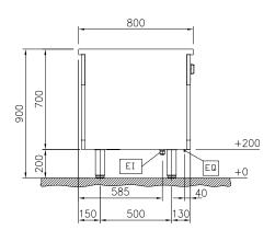
Electrical inlet (power) Equipotential screw
